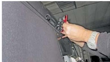
2. Die dritte Bremsleuchte aus der Halterung entfernen. Evtl. muss sie mit einem Kunststoffspachtel angehoben werden.
