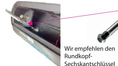
7. Die Kameragehäuse-Schrauben werden vorzugsweise mit einem Inbus-Schraubendreher mit Rundkopf festgeschraubt. Der Schraubendreher muss leicht schräg durch die Öffnung unter den Messingmuttern eingeführt werden.
