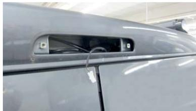
3. Den Stecker von der Bremsleuchte abziehen und parat halten um, ihn nach der Montage des Kameragehäuses wieder auf die Bremsleuchte aufzustecken.
