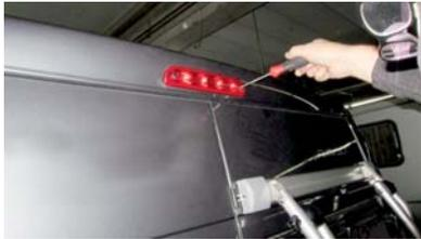
1. Die dritte Bremsleuchte muss abgeschraubt werden.
