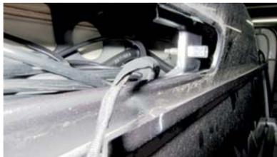
4. Das Ducato-Kamera-Gehäuse wird mit den bereits vormontierten und fixierten Schrauben an den vorhandenen Gewindemuttern befestigt.
